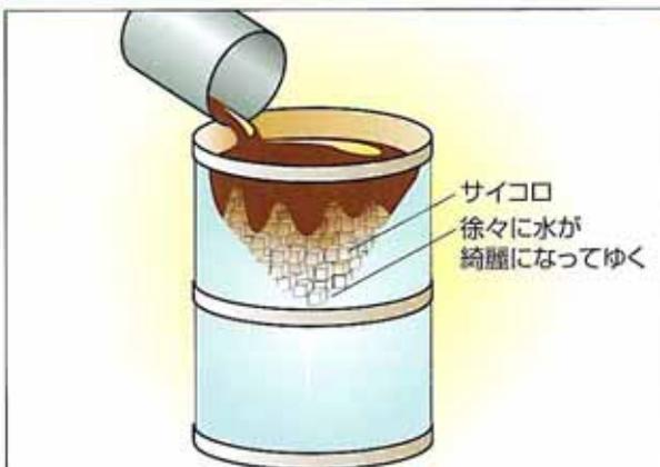
●油水分離装置にEタイプ(サイコロ)を充填しご使用下さい。
