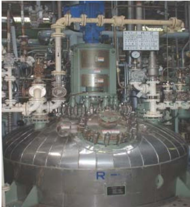
反応缶 容 量 6 0 0 0 ℓ、8 0 0 0 ℓ その他少量スケールは多目的設備を使用します(200 ℓ ~)
